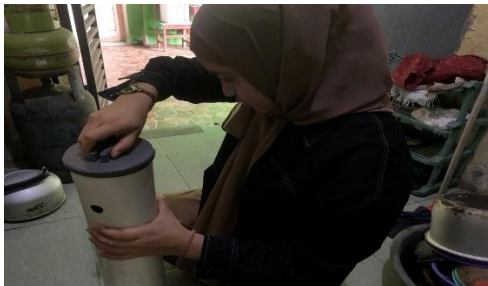
Gambar 7. Pemasangan clean out pada tabung filtrasi
