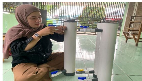
Gambar 10. Perakitan tabung filtrasi
