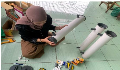
Gambar 9. Pemasangan dop Pada tabung filtrasi
