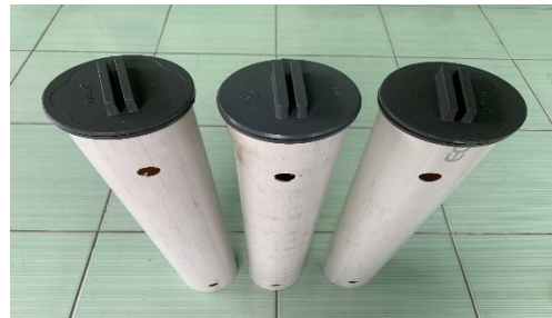
Gambar 8. Tabung filtrasi yang sudah dipasang clean out
