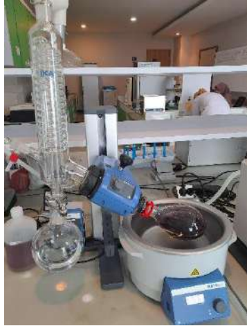
(Proses evaporasi ekstrak menggunakan Rotary evaporator )
