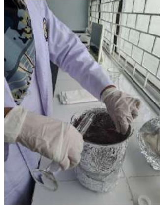
(Penuangan larutan asam sitrat pada kelopak yang dimaserasi)
