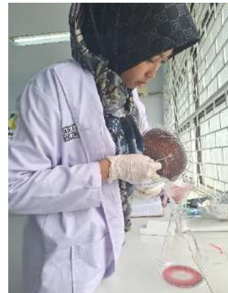
(Penyaringan ekstrak metode maserasi)
