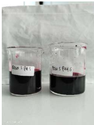
(Ekstrak yang dicampur dengan larutan buffer KCL dan natrium asetat)
