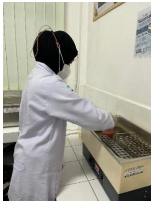
Evaporasi Ekstrak Di Waterbath
