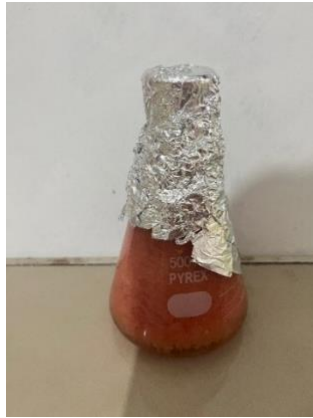
Maserasi Sampel Buah Tomat Dengan Pelarut Etanol 96%
