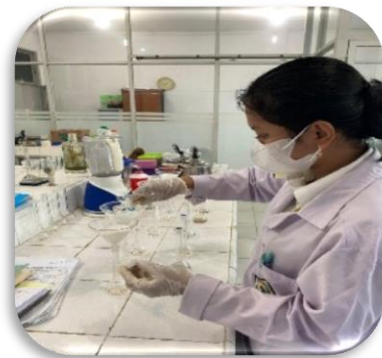
Penyaringan larutan sampel menggunakan kertas Whatman No.42
