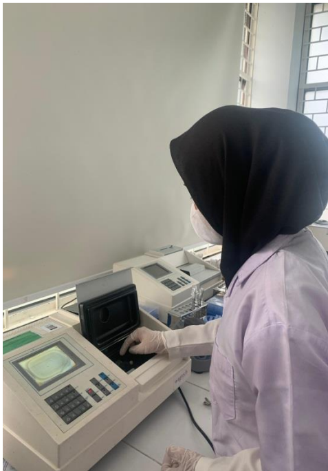
Pengukuran kekeruhan larutan pada spektrofotometer
