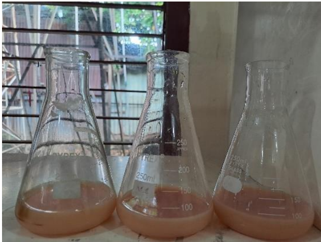
Gambar 4. Hasil titrasi pembakuan larutan titer \text{AgNO}_3
