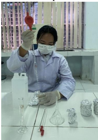
Gambar 4. Melakukan Pengenceran dengan Ethanol pada Masing-masing Sampel Hingga Mencukupi Labu Ukur 10Ml
