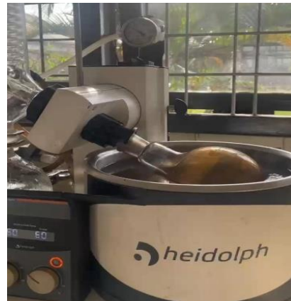
Pembuatan Ekstrak Biji Pepaya California Dengan Rotary Evaporator
