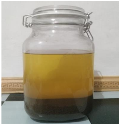
Proses Ekstraksi Dengan Metode Maserasi Menggunakan Etanol 96%
