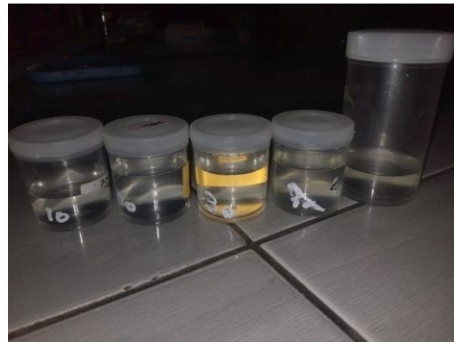
Larutan Konsentrasi (Dari kanan ke kiri : 50 ppm, 40 ppm, 30 ppm, 20 ppm, dan 10 ppm)
