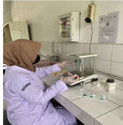
penimbangan sampel minyak goreng curah (5gr)
