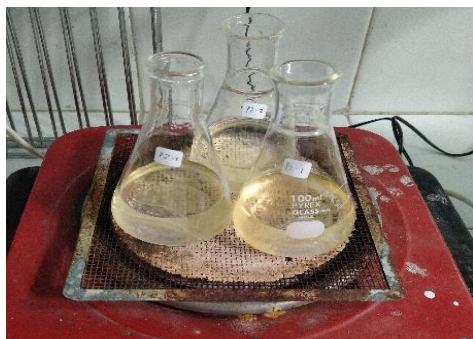
Proses Pemanasan Sampel dan Etanol 95% Selama 5 Menit
