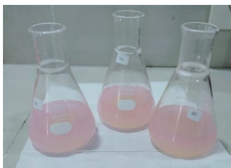
Sampel Minyak Goreng Curah Setelah Dititrasi Dengan NaOH 0,03 N
