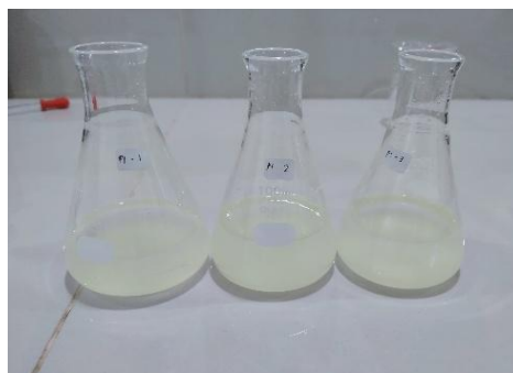
Sampel Minyak Goreng Kemasan Sebelum Dilakukan Titrasi NaOH 0,03 N
