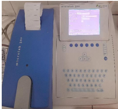
Gambar 1. Peralatan Yang Digunakan Untuk Pemeriksaan Kadar Kolesterol Total
