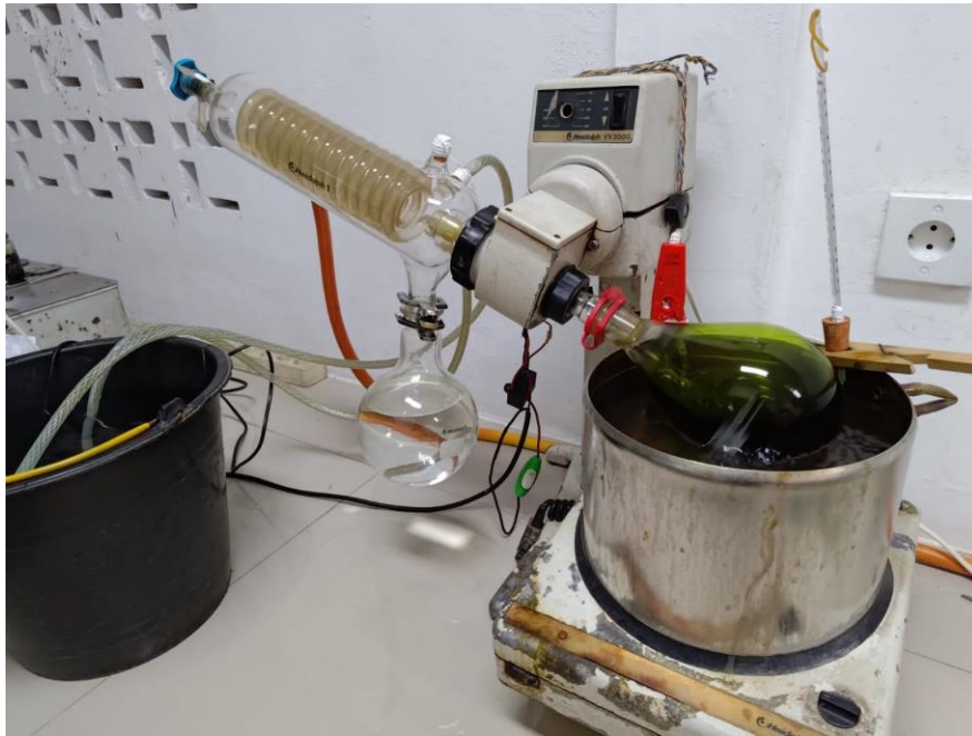
Gambar 1. Proses Pembuatan Ekstrak Kental Menggunakan Rotary Vacuum Evaporator
