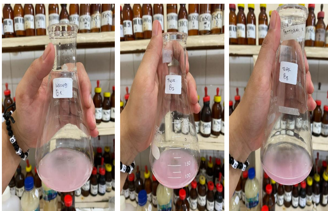
Gambar 10. Hasil Titration Sampel Tuak Warung X2
