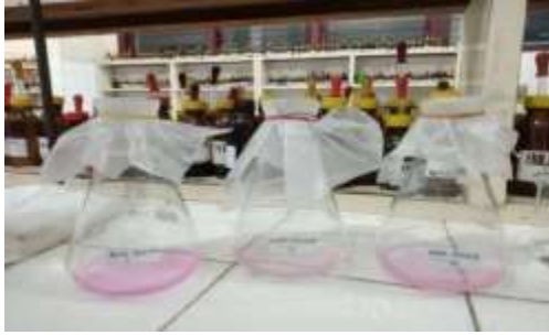
Gambar 6. Perubahan warna merah jambu pada titrasi (baku)
