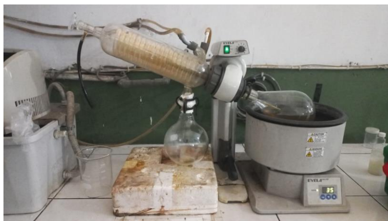
Proses Ekstraksi Daun Senggani Dengan Menggunakan Rotary Evaporator
