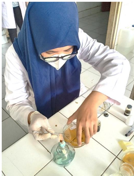
Gambar 19 Peletakkan Paper Disc Diatas Media MHA
