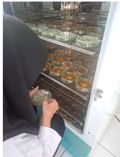
Gambar 20 Inkubasi Media Selama 24 Jam di Laboratorium Mikrobiologi
