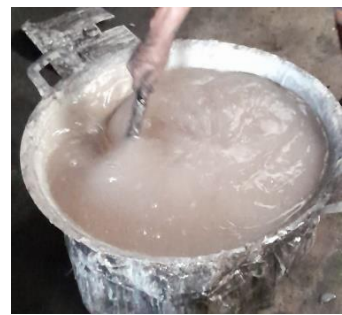
Gambar 3 : Proses pemasakan lem, pencampuran serbuk arang
