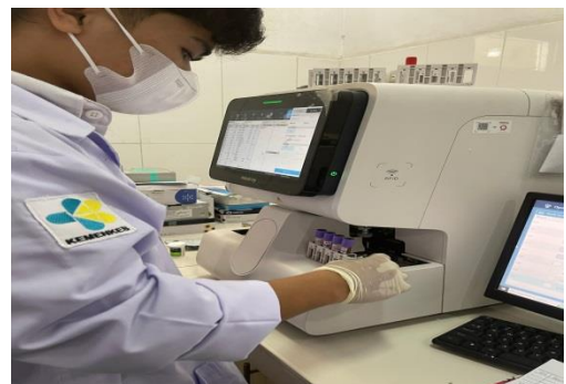
Pemasukkan Sampel Kedalam Alat Hematology Analyzer
