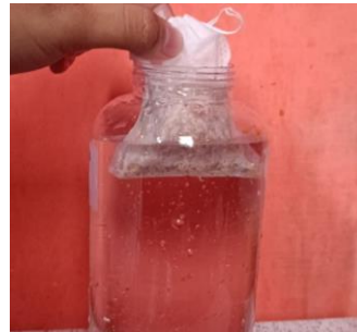
Gambar 4. Memasukkan adsorben ke botol air sampel
