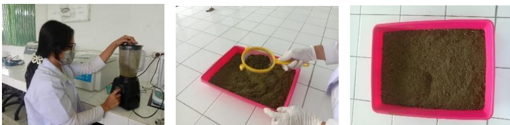
Gambar 3: Proses penghalusan dan pengayakan serbuk daun sirih
