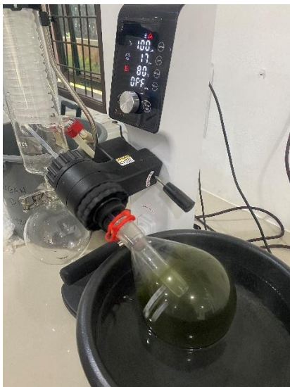
Lanjut menggunakan Rotary Evaporator untuk memperoleh ekstrak kental
