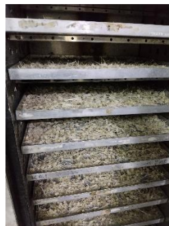
Dikeringkan dengan cabinet dryer dalam suhu 60 C selama 5 jam, diperoleh hasil 10.335 gram
