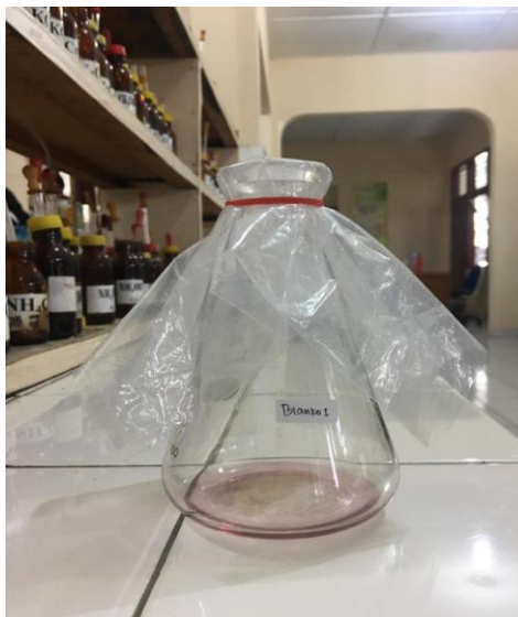
Gambar 11. Perubahan warna merah jambu pada titrasi blanko
