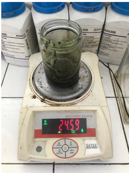
Ekstrak kental etanol daun sambiloto di timbang dan hitung rendemennya
