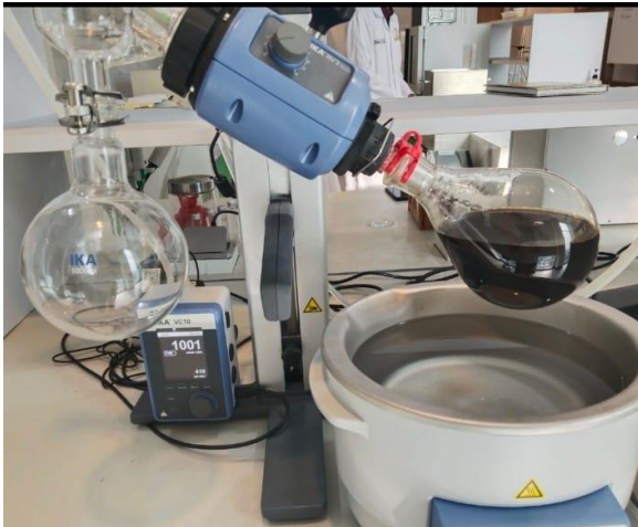
Hasil maserasi di kental kan menggunakan alat rotary evaporator untuk mendapatkan ekstrak kental etanol daun sambiloto
