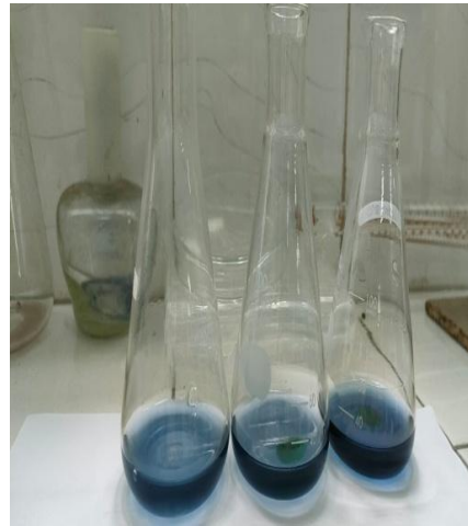
Gambar 6: Hasil Titrasi Iodium Pada Sampel Wortel Dengan Suhu 50^{\circ}\text{C}
