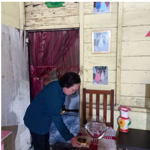
Melakukan pengukuran kondisi fisik rumah dirumah penderita ISPA (Pengukuran pencahayaan menggunakan lux meter)
