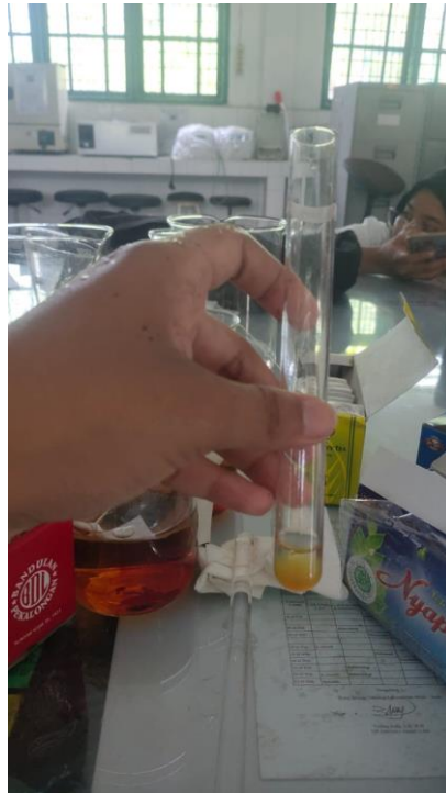
Uji kualitatif sampel menggunakan larutan \text{PbCH}_3\text{COO}
