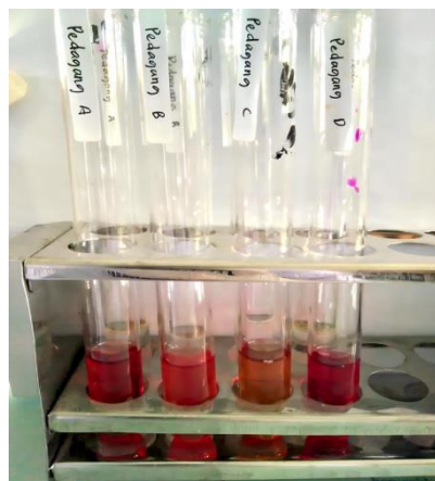
Gambar 6 : Filtrat tahu kuning sesudah ditetesi \text{KMnO}_4
