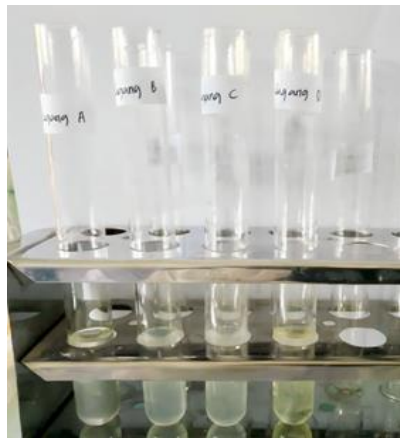
Gambar 8 : Filtrat tahu kuning sebelum ditetesi Tes Kit Formalin
