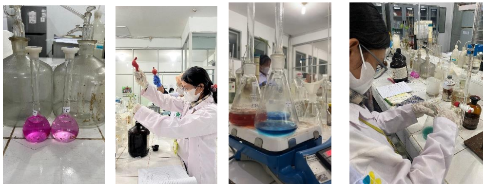
Gambar 4. Sampel yang telah di hidrolisis kemudian di tambahkan NaOH 40% dari tidak berwarna hingga berwarna merah muda setelah itu larutan hidrolisis sampel dipipet 10mL, ditambahkan aquades dan larutan luff schoorl dan batu didih lalu dipanaskan selama 10 menit angkat dan di dinginkan, kemudian dilakukan titrasi.
