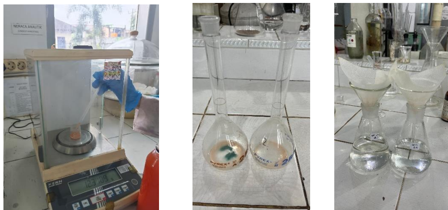
Gambar 2. Proses preparasi sampel mulai dari penimbangan hingga proses penyaringan larutan sampel.
