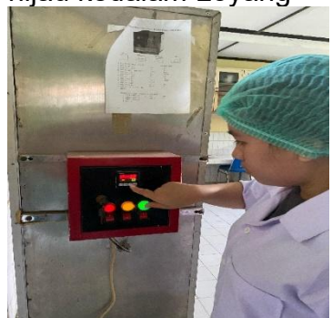
Pemanasan kabinet pada suhu 60°C
