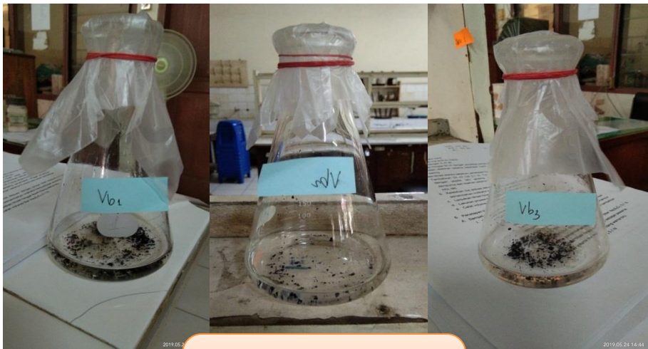
Gambar 12 Blanko setelah dititrasi
