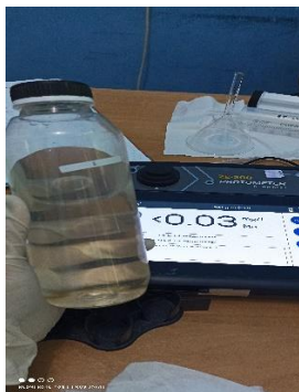
Mengukur kualitas air sampel dengan Photometer ZE 200
