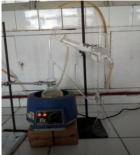
Gambar 3. Proses Destilasi Dengan Menggunakan Alat Stahl
