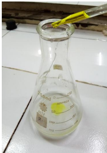
Gambar 7. Masing-masing filtrat sampel ditambahkan indikator kalium kromat.
