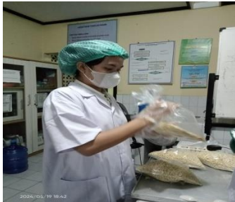
Proses pengadukan campuran serbuk andaliman dengan tepung tapioka
