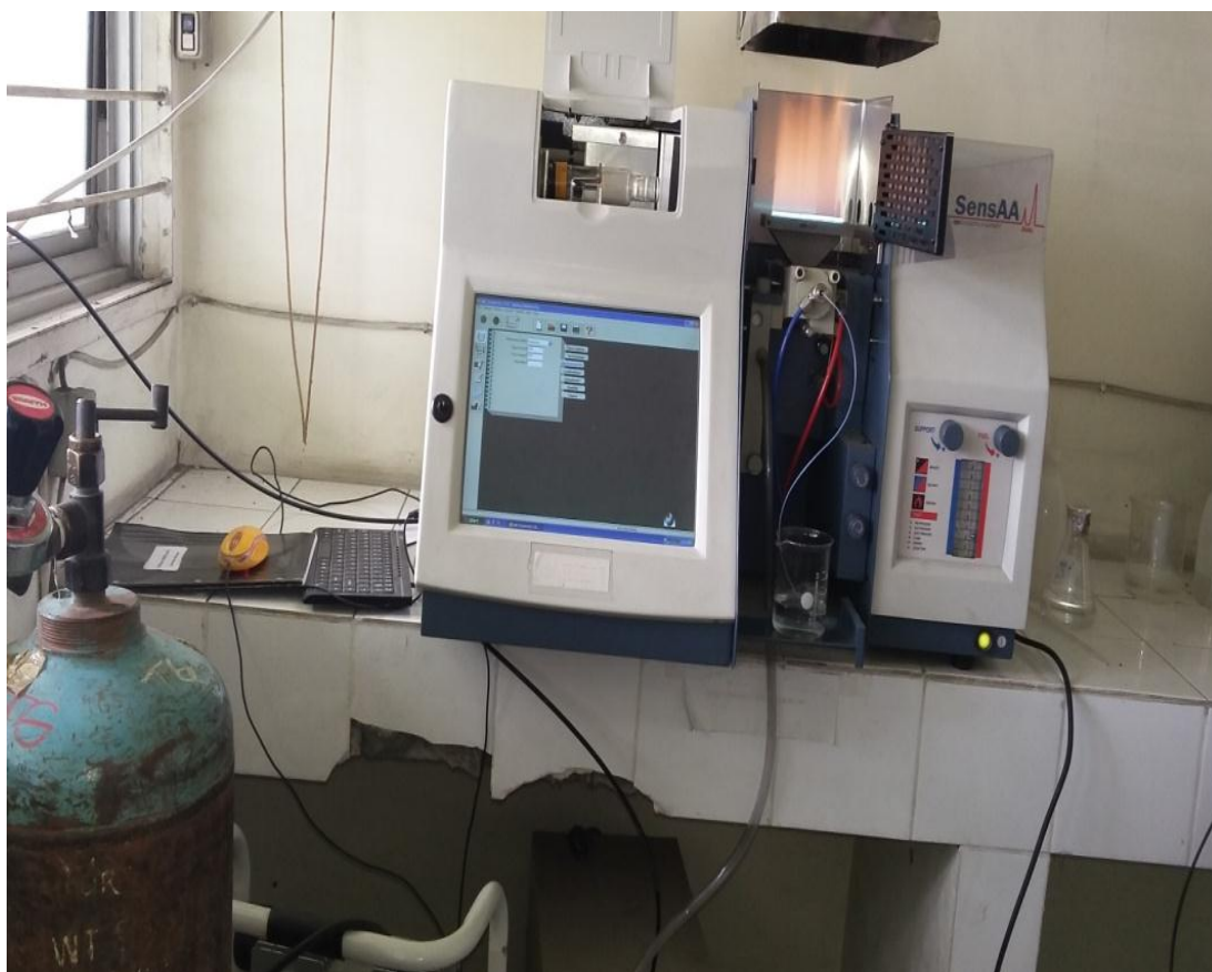
Gambar 9. Spektrofotometri Serapan Atom GBC Sens AA 2011
