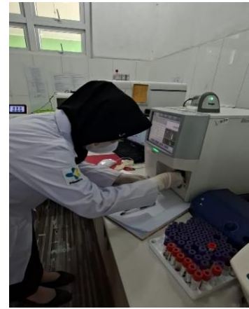
Gambar 4:Masukkan Tabung EDTA ke Hematology Analyzer
