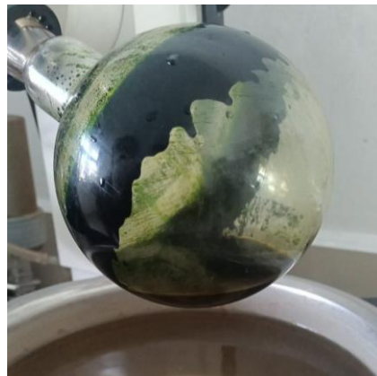
Gambar 4 Proses pemekatan ekstrak dengan alat rotary evaporator
