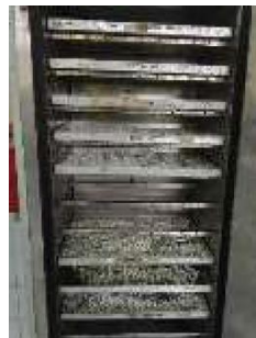
Dikeringkan di cabinet dryer dalam suhu 60°C selama 5 jam. Diperoleh hasil sebanyak 10.335 gram
