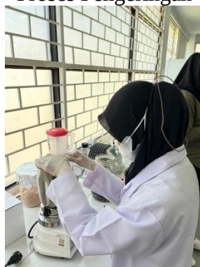
Penghalusan Simplisia Menggunakan Blender Laboratorium
