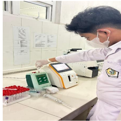
Gambar 8 Masukkan tabung Ves- tec pada alat Vas matic Analyzer
