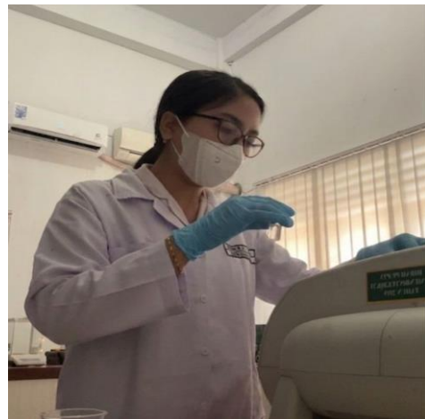
Pengukuran absorbansi menggunakan spektrofotometer
