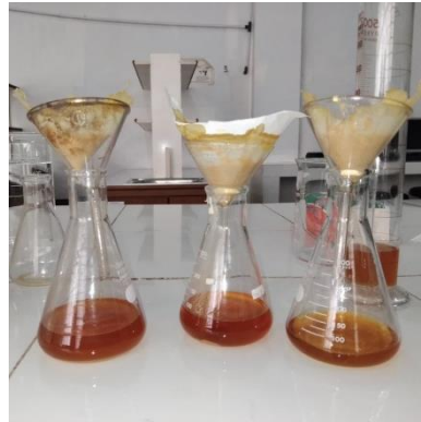
Penyaringan Hasil Maserasi 75 Bagian
