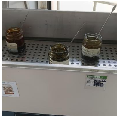
Proses Pengentalan Ekstral dengan Waterbath
