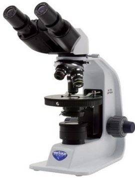
Mikroskop Binokular Yang Mempunyai Dua Lensa Okuler
