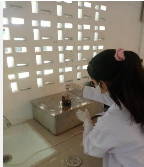
Penguapan dilanjutkan dengan waterbath pada suhu 50°C
