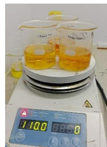
Proses destruksi menggunakan hotplate
