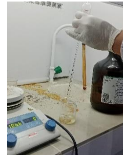
Destruksi sampel dengan Asam Nitrat ( \text{HNO}_3 ) 65%
