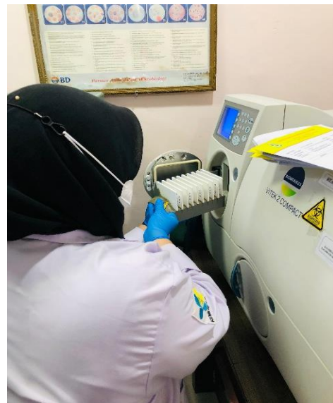
Memasukkan Ke alat VITEK 2 compact
