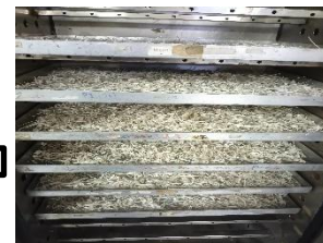
Setelah dipresto, tulang ikan dikeringkan dalam cabinet dryer
