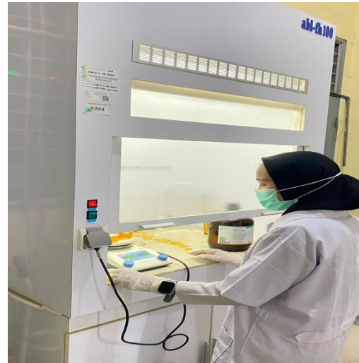
Proses pelarutan sampel dengan asam nitrat ( \text{HNO}_3 ) 65%
